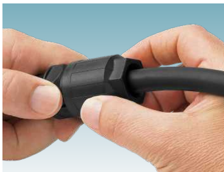
5. Sentirá que la conexión encaja en su lugar cuando se alcance el punto de apriete óptimo. La tuerca QUICKON está ahora tan apretada que ya no se puede desenroscar con la mano.
