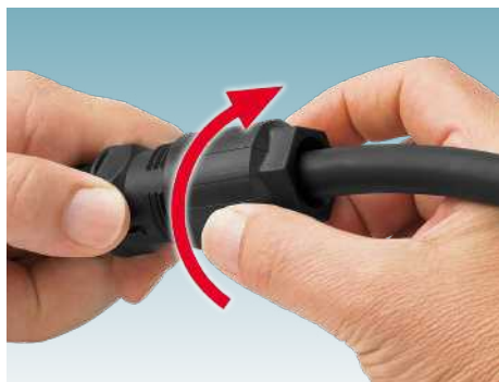
4. Colocar la tuerca de unión sobre el soporte de contactos y apretarla hasta el tope o con el par de apriete indicado.
