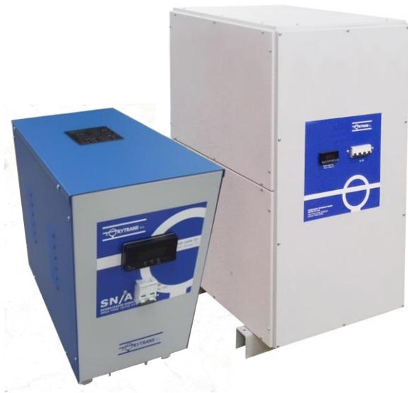
El estabilizador automático de tensión consta de un transformador booster y un autotransformador variable motorizado, de regulación por fase.
