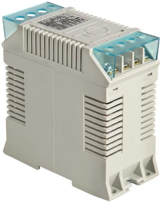
Transformador monofásico con aislamiento galvánico entre primario y secundario, su diseño compacto tiene la ventaja de ocupar menos ancho respecto a uno convencional, consiguiendo así un ahorro de espacio en el montaje de cuadros eléctricos, tanto para fijación con tornillos como en rail DIN.
