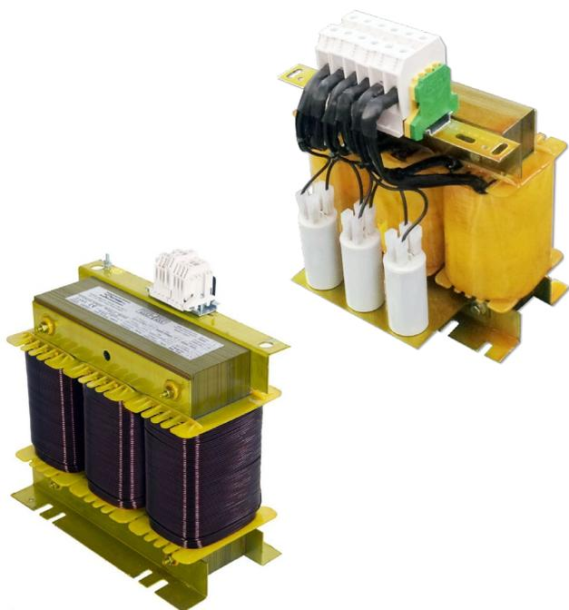
Los filtros Serie LCR Torytrans están diseñados para conectar entre la red y la entrada de los variadores de frecuencia regenerativos en aplicaciones donde la inercia mecánica de la carga puede aprovecharse para regenerar energía y devolverla a la red en el momento del frenado, como por ejemplo en motores para elevación (ascensores, escaleras mecánicas, montacargas, grúas, etc...).
