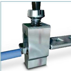
Principio de conexión de una borna de tornillo
