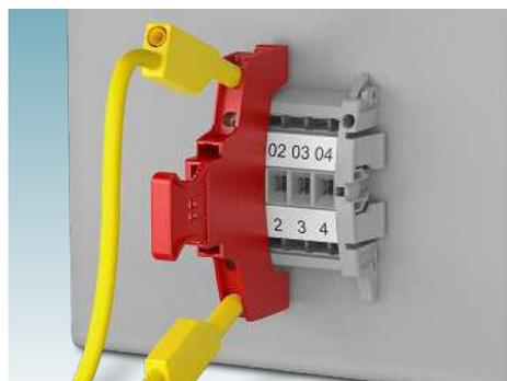
Para tareas de prueba especiales se suministran conectores de servicio con conectores hembra de pruebas de 4 mm en distintos números de polos. Mediante los conectores hembra de pruebas con las líneas de prueba de seguridad pueden insertarse en bucle p. ej. equipos de medición.
