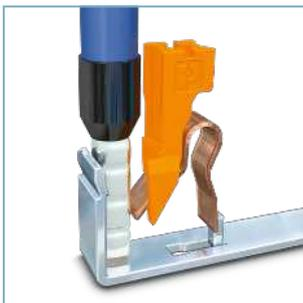
Principio de sujeción de una borna push-in
