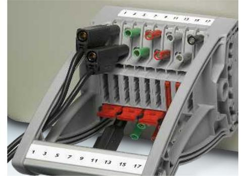
Con la utilización óptima de puentes enchufables se pueden realizar todas las conmutaciones de prueba en el conector macho. Los conectores hembra de pruebas asignados de manera alternada permiten utilizar líneas de prueba de seguridad en espacios estrechos.
