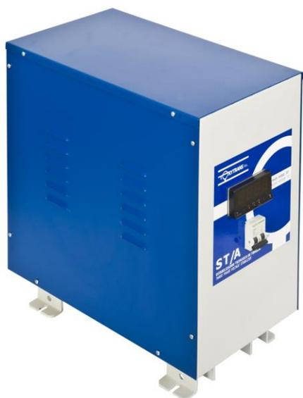
El estabilizador automático de tensión consta de un transformador booster y un autotransformador variable motorizado, de regulación por fase.
