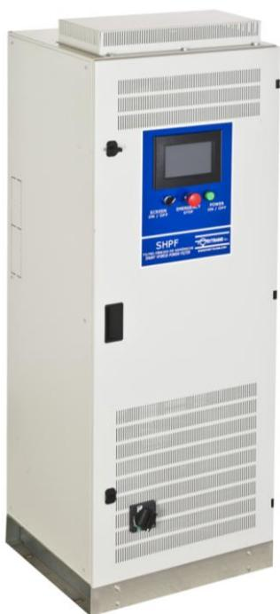
Filtrado de los armónicos de corriente y compensación de la potencia reactiva en redes trifásicas con neutro. Corrige el factor de potencia en instalaciones con armónicos aumentando la potencia activa útil disponible.
