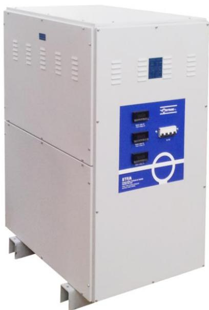
El estabilizador automático de tensión consta de un transformador booster y un autotransformador variable motorizado, de regulación común "serie ST" o independiente por fase "serie STF".
