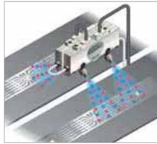
Eliminación de cargas electrostáticas en soportes para el transporte de LCDs
