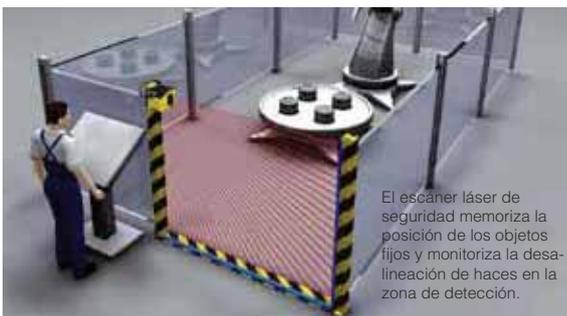
El escáner láser de seguridad memoriza la posición de los objetos fijos y monitoriza la desalineación de haces en la zona de detección.
