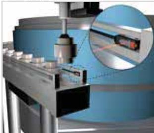
**Detección de presencia y/o ausencia en bandejas de tubos de ensayo**
