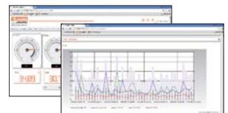
Sistema con server-multiclient basado en MS SQL RDBMS con puerto web-browser. Gestión simultánea de varios canales de comunicación con configuración independiente (protocolos, velocidad, RS232, RS485, Ethernet, módem). La interfaz visualiza en directo las tablas de registro de datos, gráficos y alarmas.
