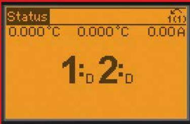
Lea el estado del compresor directamente en el display. D = control de velocidad variable, O = Off, R = funcionamiento de red, X = Desactivado
